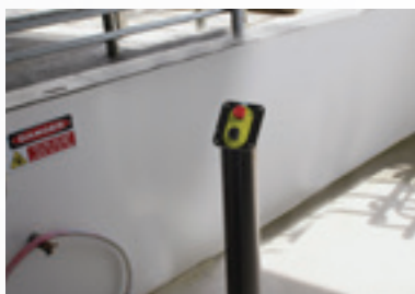
Consola del operador de la plataforma: parada de emergencia Se puede activar en caso de emergencia.
