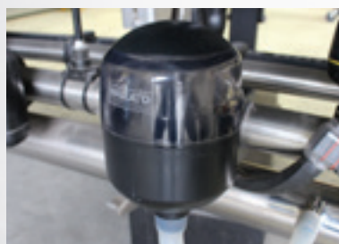
Medidor de leche electrónico Datos de ordeño en tiempo real para monitorear el rendimiento
