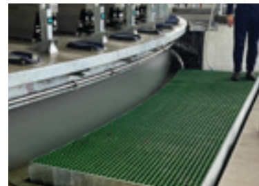
ELEVADOR para el operador Piso electrónico con altura regulable
