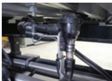
Válvula de cierre de Vortex Válvula de corte de leche de alto rendimiento
