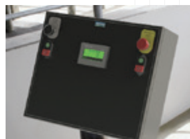
Consola del operador de la plataforma: pezoneras desactivadas Segunda consola para mayor comodidad a la hora de quitar las pezoneras
