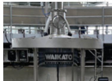
Sistema de posicionamiento de plataforma Datos precisos sobre la ubicación de la plataforma de ordeño
