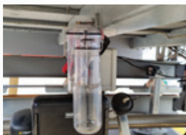
Muestreador WMS Toma muestras para un análisis preciso de la leche.
