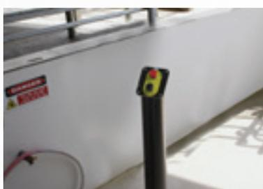
**Consola del operador de la plataforma: parada de emergencia**
