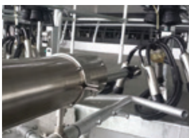
Brazo rociador Waikato Rociado automático de pezones para rotativas rápidas
