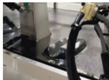
Borde seco / Riel perimetral de acero inoxidable Permite que el agua se drene lejos del operador.
