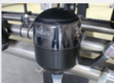
Medidor de leche electrónico Datos de ordeño en tiempo real para monitorear el rendimiento
