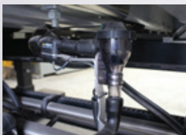
Válvula de cierre de vórtice Válvula de corte de leche de alto rendimiento
