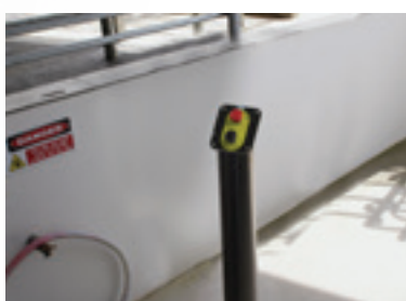
Consola del operador de la plataforma: parada de emergencia Se puede activar en caso de emergencia.
