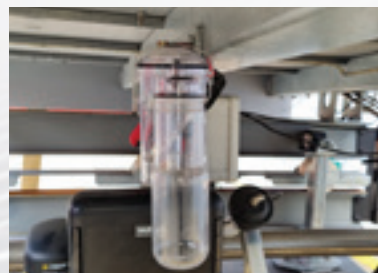
Muestreador WMS Toma muestras para un análisis preciso de la leche.
