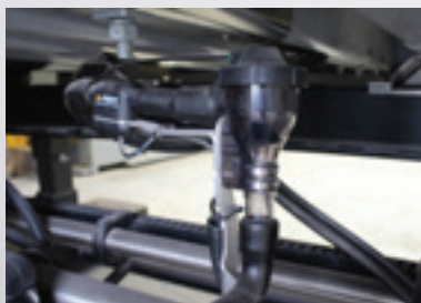
Válvula de cierre de vórtice Válvula de corte de leche de alto rendimiento
